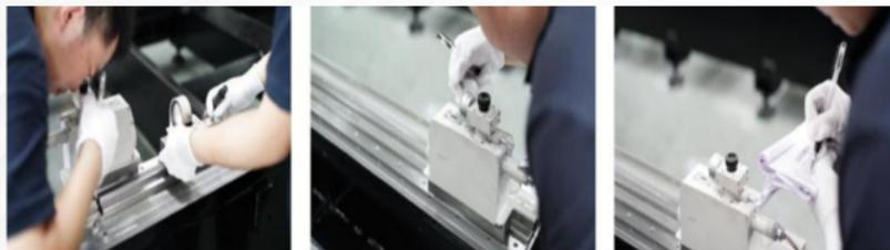
3. El colimador de haz corporal detecta la superficie del riel guía y mide la rectitud del riel guía para garantizar la precisión de cada equipo.
