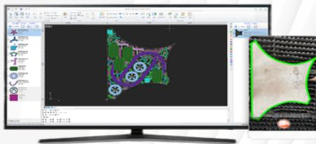
Cypnest es un conjunto de software de anidamiento utilizado en el sistema NC de corte por láser planar de Baichu. Para el desarrollo del software de corte planar Baichu HypCut/CypCut, puede realizar un anidamiento rápido, procesamiento de dibujos, edición de trayectorias de herramientas, generación de formularios y otras funciones.
