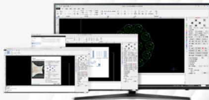
Cypcut es un software ampliamente utilizado para el proceso de corte por láser, con una gran base de clientes y comentarios, rendimiento estable y funciones integrales. Las funciones principales incluyen el procesamiento gráfico, la configuración de parámetros, la edición del proceso de corte definido por el usuario, el diseño, la planificación de rutas, la simulación y el control de corte.
